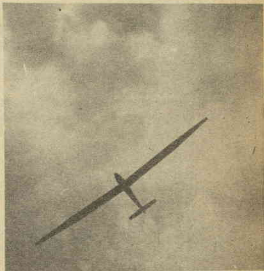
Un aliante in volo; notare il particolare, comune a tutti gli alianti, dell'apertura alare molto ampia rispetto alle altre dimensioni dell'aereo.
